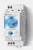
Descrizione tecnica: Interruttore orario, Interruttore digitale astronomico, programmazione con NFC, larghezza 35 mm, 1 Scambio, 16 A, Tipo di alimentazione AC/DC, tensione di alimentazione nominale 230 V, funzionamento da 88 a 264 V (AC)/(DC), potenza nominale 2.8 VA (AC) / 0.9 W (DC), Opzione: con riserva di carica, temperatura ambiente da -20 a +50 °C
