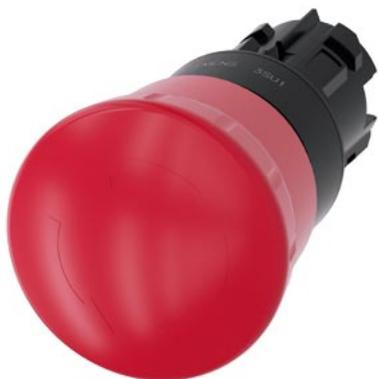
pulsante a fungo di ARRESTO DI EMERGENZA, 22 mm, rotondo, in plastica, rosso, 40 mm, permanente con blocco positivo, secondo DIN EN ISO 13850, sblocco a rotazione
